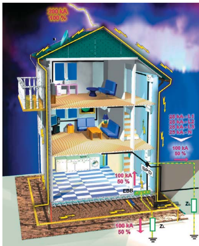
Рис. 60. Распределение тока в случае попадания молнии в строение с установленной внешней системой грозовой защиты
