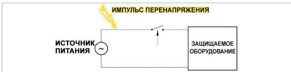
Рис. 40. Включение элемента защиты от перенапряжения последовательно с линией
