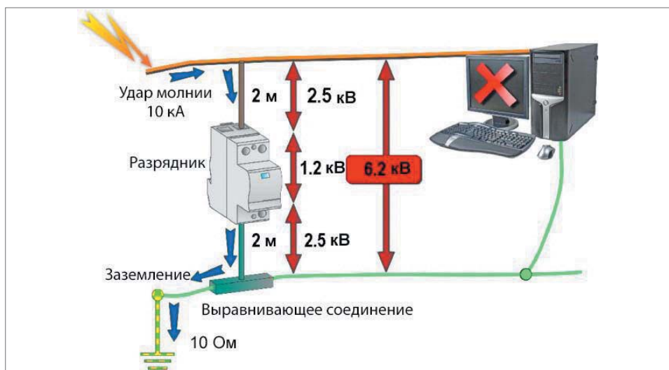
Рис. 38. Условия работы УЗИП
